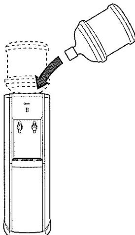
ウォーターガードの中央部のパイプヘボトルを逆さまにして手早くしっかり差し込みます。
