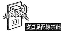
電源プラグをコンセントに差し込み、背面にある温水スイッチをONにします。冷水スイッチはありませんが、この時点で自動的に冷却も開始されます。尚、コンセントのタコ足配線は発熱し、火災の恐れがありますので単独で使用してください。
