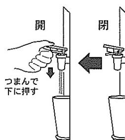
ボトルをセットしたら、すぐ図のように温水フォーセットを下に押し続け、温水タンク内のエアー抜きを行ってください。約1分程で温水フォーセットより水が出ます。水が出たらエアー抜きが完了です。
